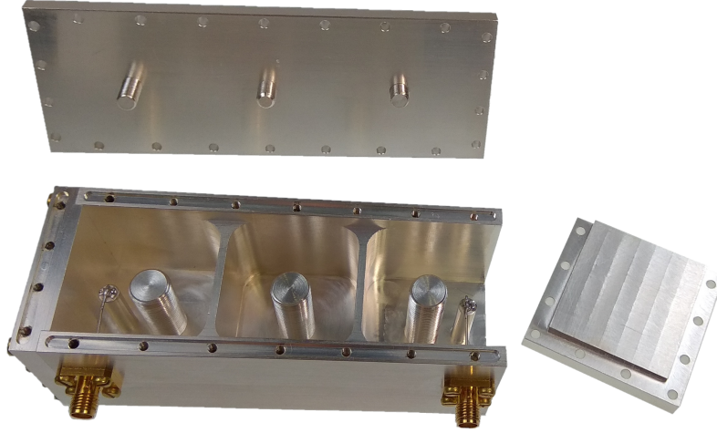
Abbildung 5.21: Gefertigtes und versilbertes Filter aus Aluminium [75].
